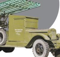
Боевая машина реактивной артиллерии «Катюша». Солдаты Третьего рейха называли её «орган Сталина» из-за звука, издаваемого оперением ракет. Смонтированная на основе грузовика повышенной проходимости ЗиС-6, внешне БМ-13 выглядела опасно, но 16 реактивных снарядов, крепящихся на рельсы направляющих установок, били более чем на 8 километров.
